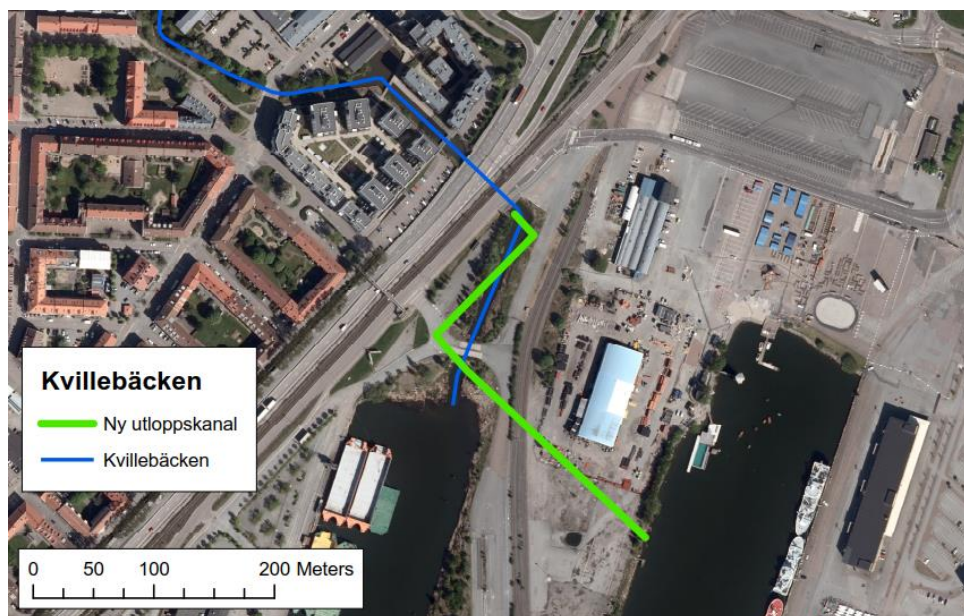
Figur 1. Översikt över Kvillebäckens utlopp till hamnen. Blå linje visar Kvillebäckens befintliga sträckning. Grön linje visar den nya utloppskanalens sträckning.
